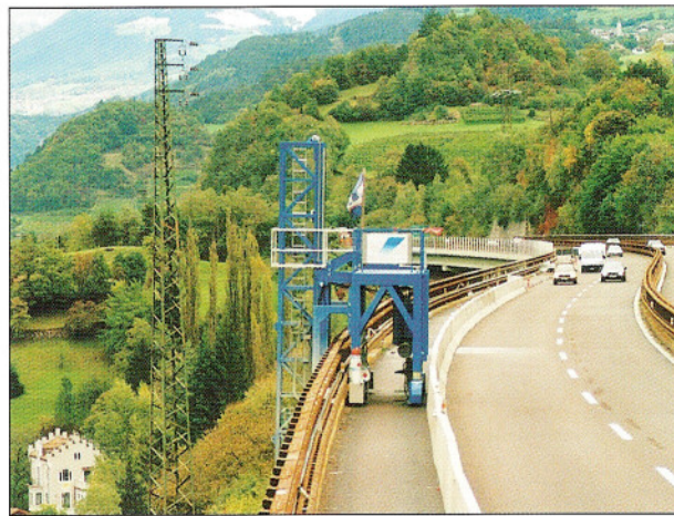
Dimostrazione del poco spazio richiesto sul ponte, meno di 2 metri.
