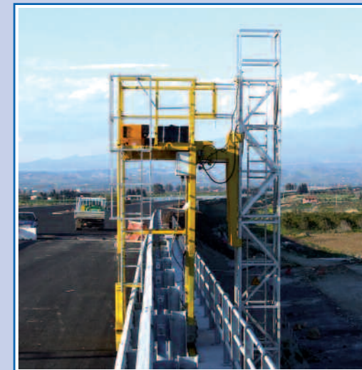
Il braccio estensibile con la telecamera ispeziona la struttura sottoponte (Brevettato)
