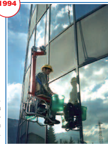
Sedile sospeso, secondo la norma EN 1808, equipaggiato con motore a scoppio. (Brevettato)
