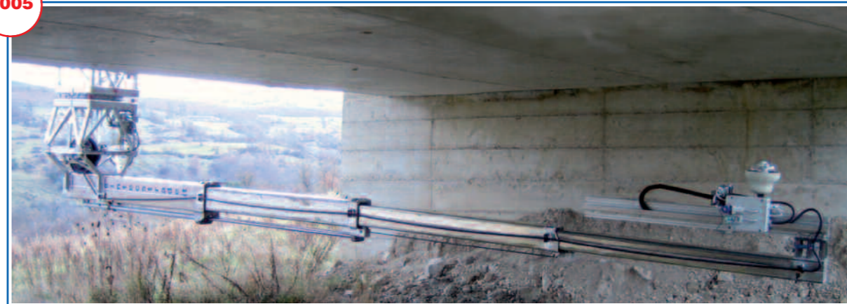
Il braccio estensibile con la telecamera ispeziona la struttura sottoponte (Brevettato)
