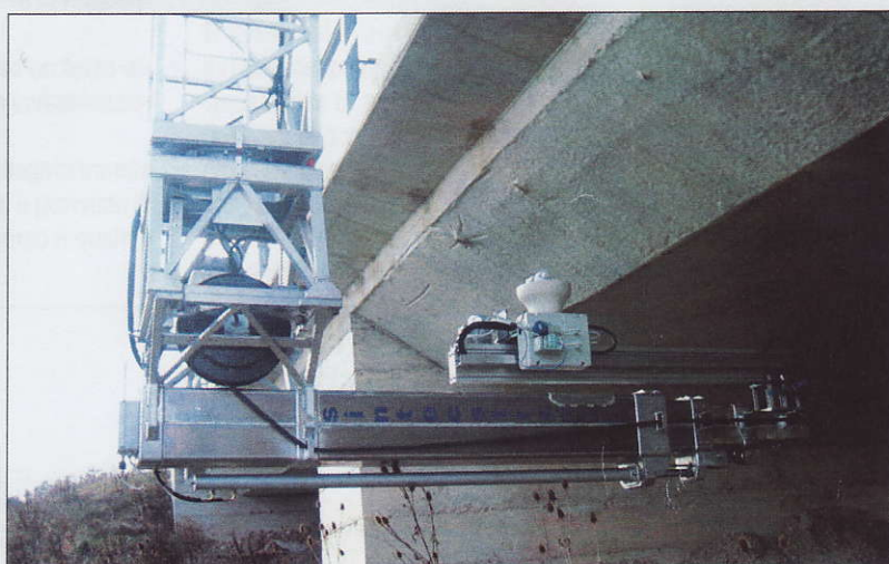
Figura 1 - Il sistema di monitoraggio programmato innovativo per l'ispezione degli intradossi di ponti e viadotti
