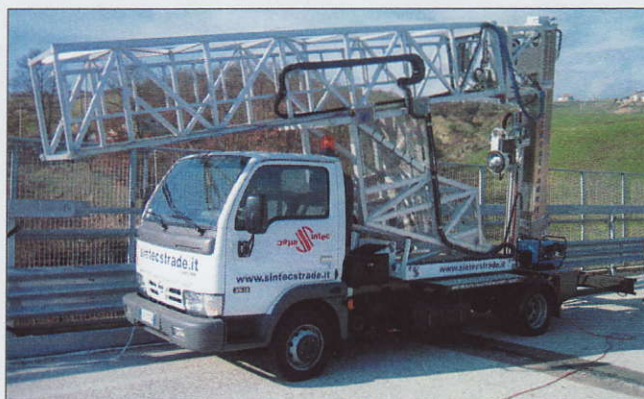
Figura 8 - Il veicolo attrezzato con la struttura e il braccio estensibile
